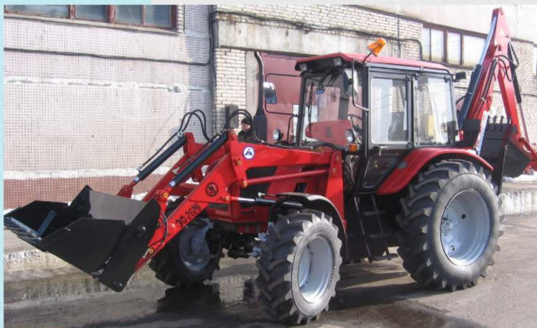
ЭО-2626 с двухчелюстным ковшом и грузовыми вилами
