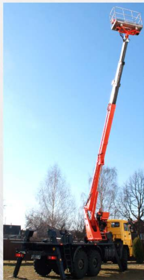
Подъемник автомобильный телескопический ПМС-328-09 грузовая характеристика
