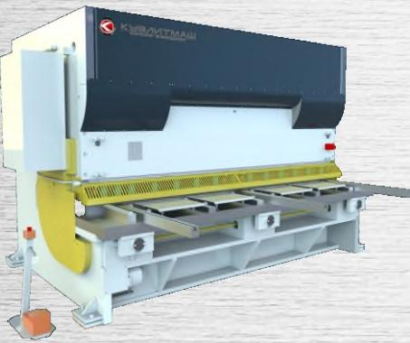
Ножницы (гильотинные) листовые гидравлические с наклонным ножом предназначены для резки листового металла.
