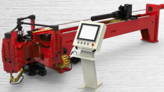
Технологическое оборудование с ЧПУ для гибки труб модели АГС60 предназначено для гибки трубчатых стальных деталей в автоматическом режиме с функцией пробивки отверстия на проход.
