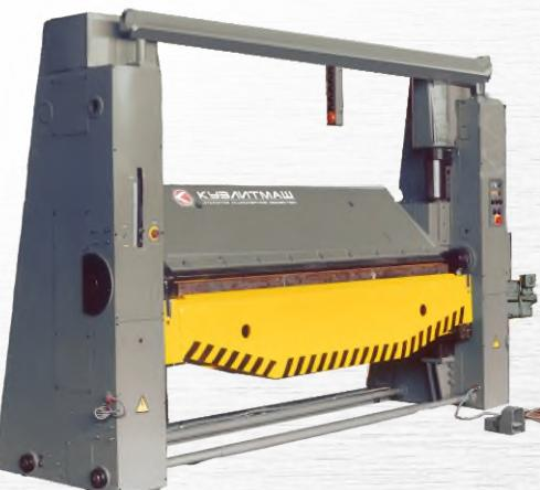
Предназначена для изготовления различных деталей из листового проката методом гибки.
