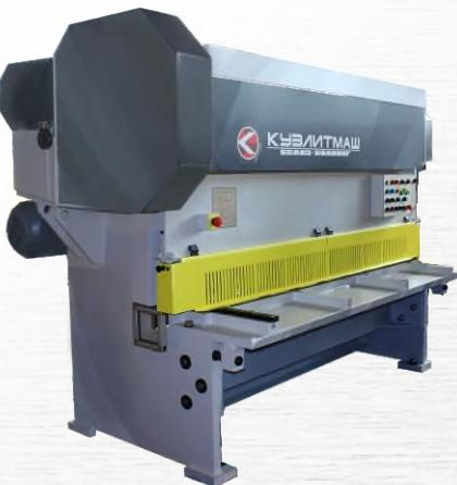
Применяются в заготовительных и ремонтных цехах машиностроительных предприятий. Могут использоваться в составе автоматизированных комплексов и автоматических линий.
